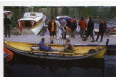
Denne Åfjordsbåten, «Landkrabben», ble bygget i regi av Fosen Folkehøyskole der «landkrabbene» Torgeir Stenvold (på bildet), Bente Wallevik (på bildet) og Øystein Elgvasslien har gjort alt arbeidet selv inkludert seil, beslag, trearbeide osv. Til og med impregneringsstoffet til seiltrådene har de laget og kokt selv.
